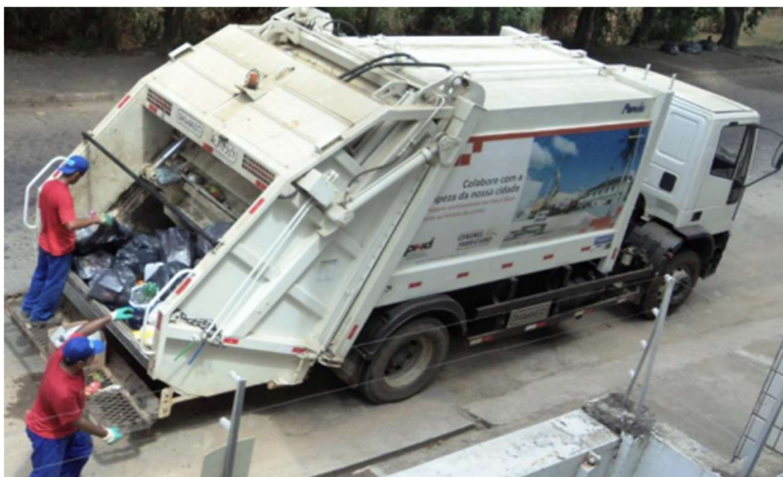
Fotografia 13-1 - Caminhão coletor compactador (manual) para coleta convencional.
